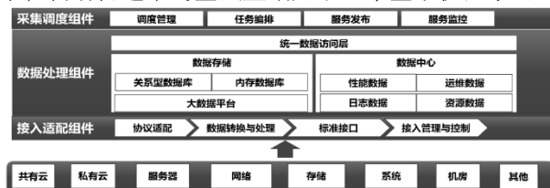
图 3: 多协议接入适配网关
