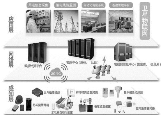
图 1-1 卫星物联网体系结构
